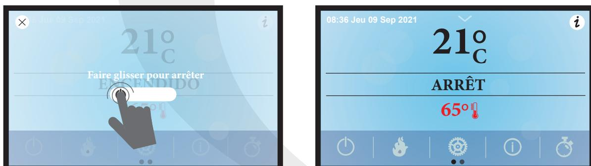
Appuyez sur le bouton P1 de façon prolongée, faites glisser vers la droite et la chaudière entrera en procédure d'arrêt jusqu'à arriver à l'état OFF.
