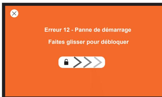
Lorsque ce message s'affiche sur le panneau de contrôle, la chaudière est prête à être débloquée et utilisée à nouveau. Faites glisser comme cela est indiqué sur l'écran et débloquent.
