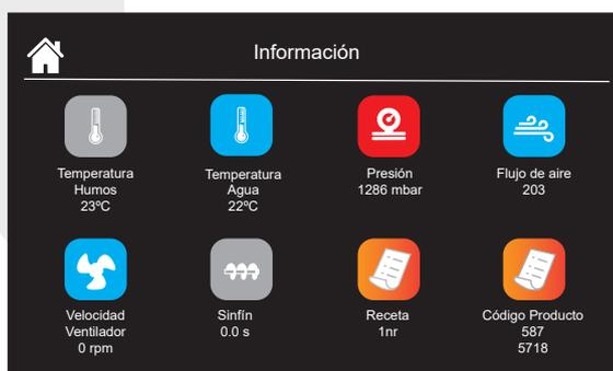
Sur la lecture de l'image précédente, vous pouvez voir les informations offertes: température des fumées, température de l'eau, pression, flux d'air, vitesse du ventilateur d'extraction des fumées, temps de travail de la vis sans fin, recette appliquée à la configuration de la chaudière et code produit.
